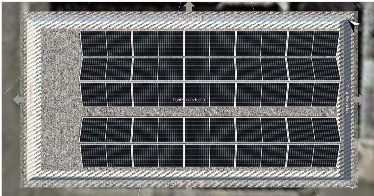
Obrázek: Pokrytí budovy 01 fotovoltaickými panely
